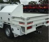
3 X UNDER TRAY TOOLBOXES, 1 X UNDER TRAY WATER TANK, VICE SLIDE AND 1200MM TOOLBOX LEFT HAND SIDE.
